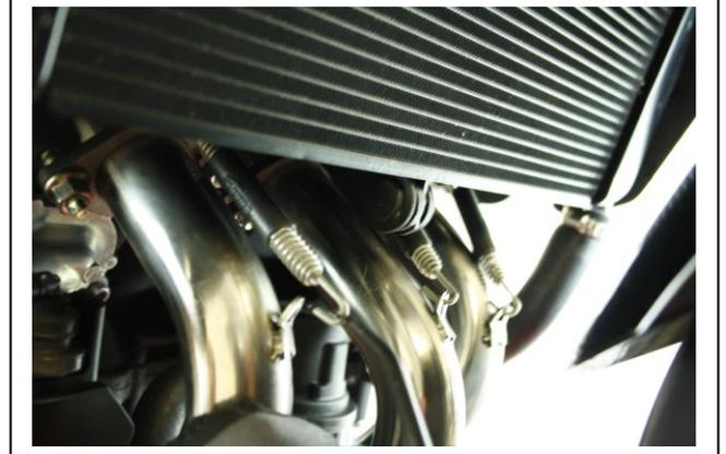
2. Schrauben Sie nun die Lambdasonde wieder ein, verlegen das Kabel nach oben, schließen den Stecker wieder an und ziehen Sie die Schutzhülle über die Steckerverbindung. Ziehen Sie nun die Lambdasondenschraube wieder fest an.
