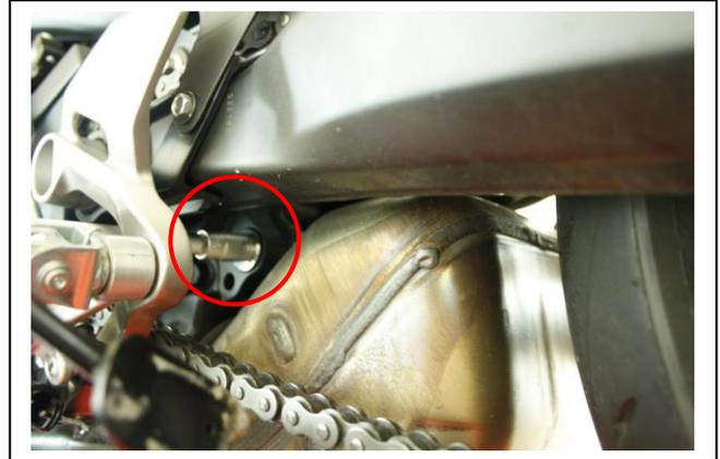
4. Lösen Sie nun alle 6 Muttern an den Stehbolzen der Zylinder, entfernen Sie dann die bereits lockere Schraube am Endschalldämpfer und entfernen Sie die gesamte Anlage in einem Stück.
