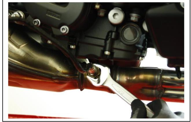
3. Lösen Sie nun die beiden Befestigungsschrauben des Endschalldämpfers unterm Motor. Lassen Sie jedoch die Schraube in Fahrtrichtung rechts noch montiert, so dass die Anlage später nicht herunterfallen kann.
